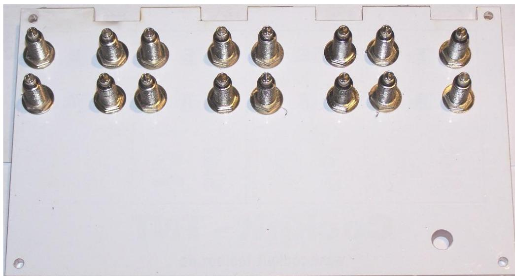
Natürlich kann eine solche Frontblende auch in Eigenregie, z.B. aus Aluminium gefertigt werden. Allerdings sind dann isolierte 4 mm Buchsen erforderlich. Die hier gezeigte Kunststoffausführung kommt ohne diese Isolierung aus.
